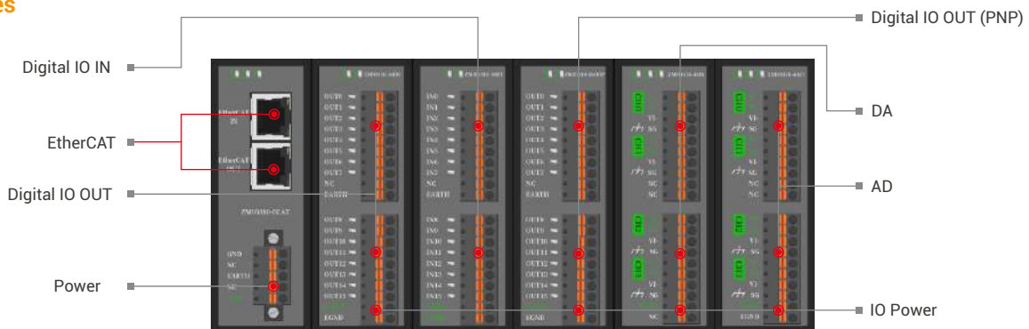
ZMIO310 EtherCAT Bus Module
